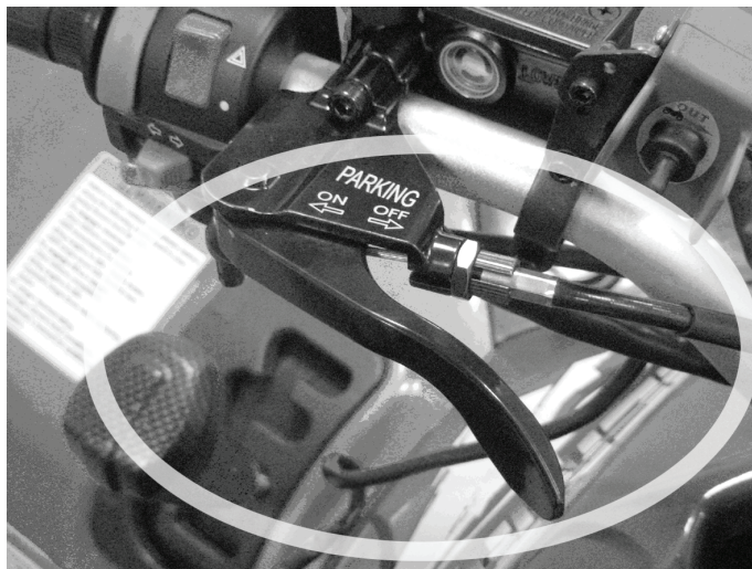
Рычаг стояночного тормоза в положении - „ OFF ” (выключено)
