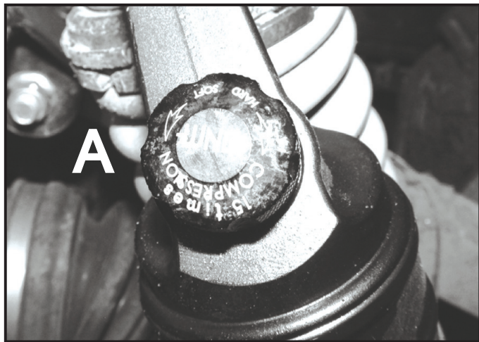
„А” - Винт регулировки жесткости амортизатора.
